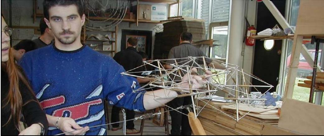
*Dans les structures double-nappes planes, ou dalles en treillis, tous les nœuds sont situés sur deux plans parallèles, les membrures appartenant à chacun de ces plans sont disposées régulièrement et forment une tessellation.*
