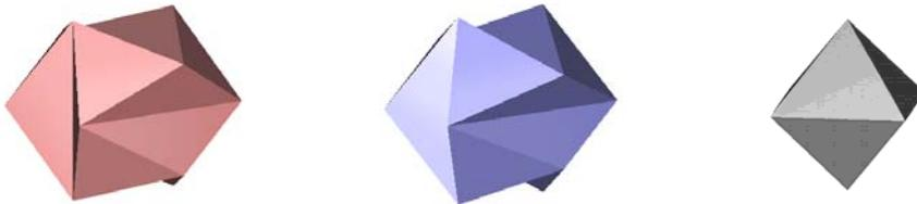
3. L'extension des barres provoque la pliure des faces carré du cuboctaèdre qui se transforment en deux triangles, soit des volumes à 20 faces. Le position ultime est atteinte lorsque les plis se referment, il n'y a plus que 8 triangles: un octaèdre
