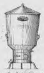
Appareil à l'eau chaude pour le chauffage.
