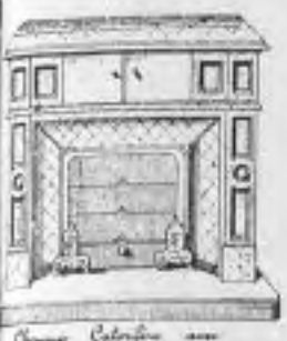
Cheminée Calorifère avec Chauffage.
